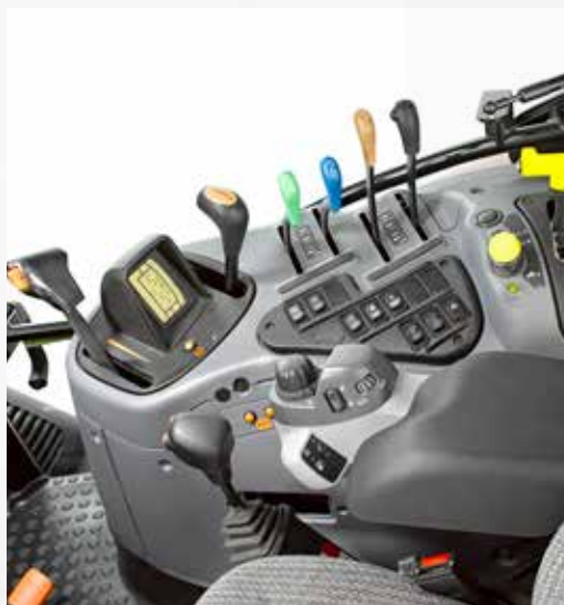
Model Profi Classic wyposażono w mechaniczne zawory hydrauliki zewnętrznej i elektroniczne sterowanie zaczepem (EHR).
