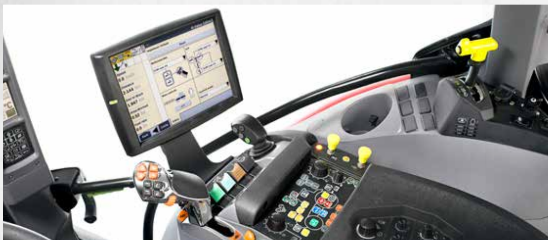
Model Profi Classic wyposażono w mechaniczne zawory hydrauliki zewnętrznej i elektroniczne sterowanie zaczepem (EHR).
