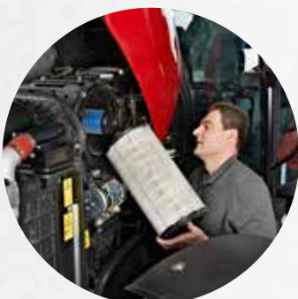
Ciągłe czyszczenie za pomocą filtra Piclon sprawia, iż prace konserwacyjne są wymagane tylko wtedy, gdy zaświeci odpowiednia lampka ostrzegawcza.
