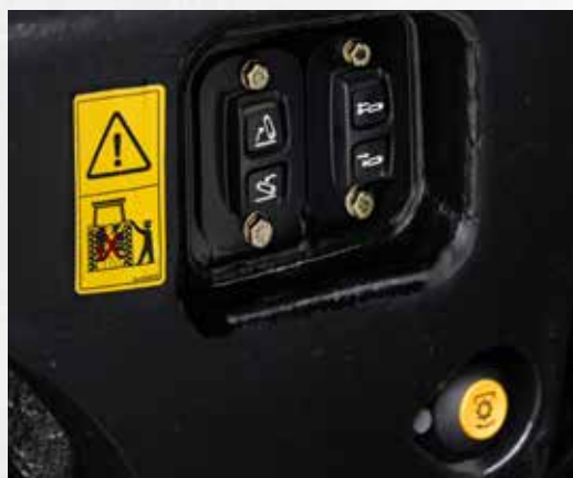
Tuż pod ręką: Zewnętrzne włączniki przedniego TUZ, WOM i przedni moduł sterujący.
