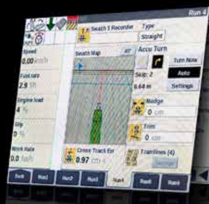
S-Turn II automatyzuje skręt na końcu ścieżki
