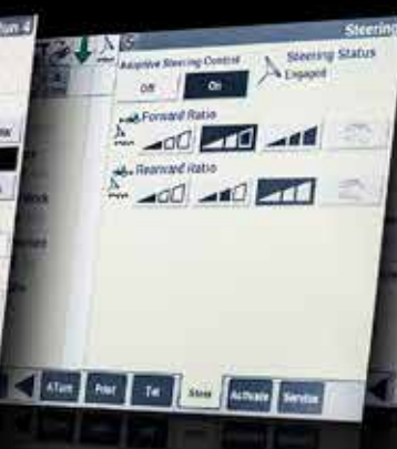
QuickTurn II: adaptacyjny układ kierowniczy (ASC) pozwalający szybciej wykonywać skręty
